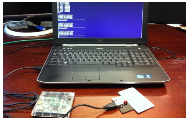
Figur 7: Arbetsplats, visar Proxmark3 inkopplad till dator med tillhörande högfrekvent antenn och en Mifare Classic etikett.
