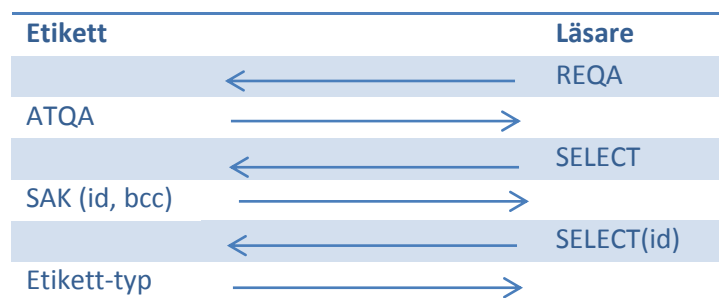
Figur 19: Anti-kollisionsprotokoll mellan etikett och läsare.
